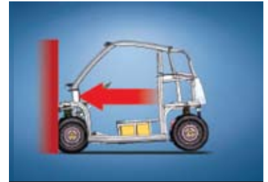
PRUEBAS DE IMPACTO HASTA 30 MPH
